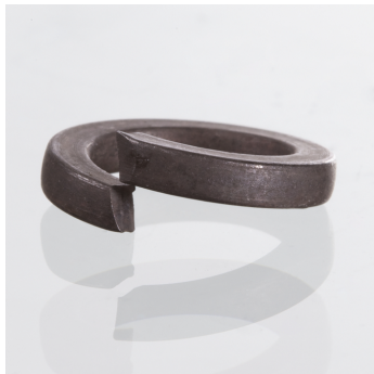
Modelis Atspergredzens Standarts DIN 127, B-veida Materiāls Atsperu tērauds
